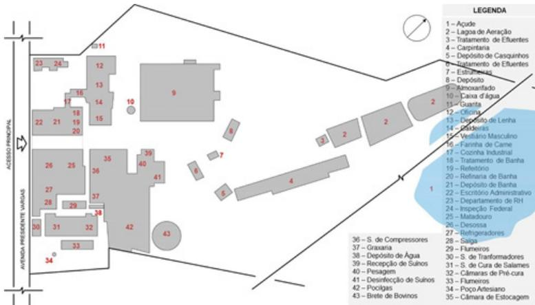
Figura 2: Esquema de implantação do Frigorífico Z. D. Costi (sem escala). Fonte: Elaboração própria com base nas plantas levantadas no Arquivo Histórico Regional.
