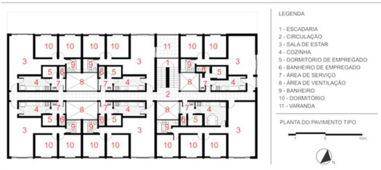
Figura 7. Planta baixa do pavimento tipo do edifício dos Bancários em Passo Fundo. Fonte: Arquivos do INSS-RS, 2019 (adaptação própria).
