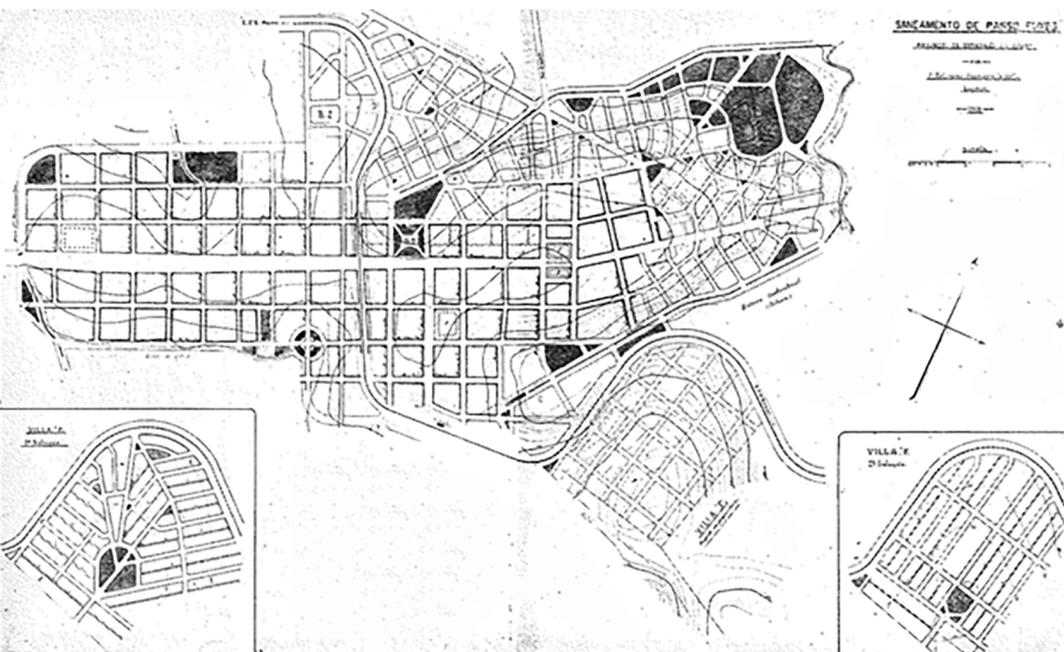
Figura 3: Planta da cidade de Passo Fundo (RS), elaborada por Saturnino de Brito em 1919. Nesta figura se pode observar, abaixo, no canto esquerdo, a primeira solução para a implantação da “Villa F.” e, no canto direito, a segunda solução. Em ambas a topografia é considerada como elemento de conformação do bairro. Fonte: BRASIL. Ministério da Educação e Saúde (1943, p. 163, v. XI) (adaptado pelos autores, 2021).
